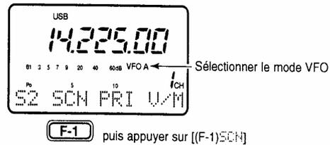
**Note :** Si les canaux 1A et 1B comportent les mêmes fréquences, le balayage ne démarre pas.
