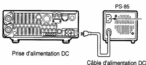
A relier sur une source de tension AC à l'aide du câble fourni.
