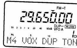
**NOTE :** Lorsque vous souhaitez transmettre une tonalité 1750 Hz, en appuyant sur [PTT], appuyez simultanément sur [(F-3)TON] dans le menu M4 en mode répéteur.
