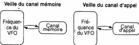
Ce type de balayage fonctionne en mode VFO.
