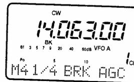
Le mode CW en semi break-in est sélectionné.
