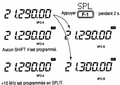
Par défaut, la fonction semi-duplex rapide est activée. Au besoin, elle peut être annulée dans le mode de réglages initiaux (p. 51). Dans ce cas, en appuyant sur [(F-1)SPL] pendant 2 sec., on obtient le même résultat qu'avec [(F-1)SPL] dans le mode semi-duplex normal.
