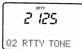
La fréquence de la tonalité est fixée à 2125 Hz. Les fréquences 2125 et 1615 Hz sont disponibles.
