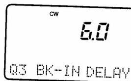
Un délai équivalent à 6 points est sélectionné dans le menu des réglages rapides.
