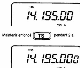
La fréquence change au pas de 10 Hz en tournant le vernier principal.
