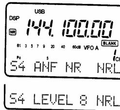
✎ **NOTE** : Le réducteur de bruit est automatiquement mis en service en appuyant sur [(F-3)NRL]. Cependant, l'émetteur-récepteur maintient la condition "ON/OFF" en appuyant sur [(F-2)NR].
