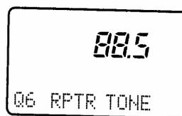
Sélectionner une tonalité (mode de réglages rapides). Voir p. 49 pour les détails et les fréquences disponibles.
